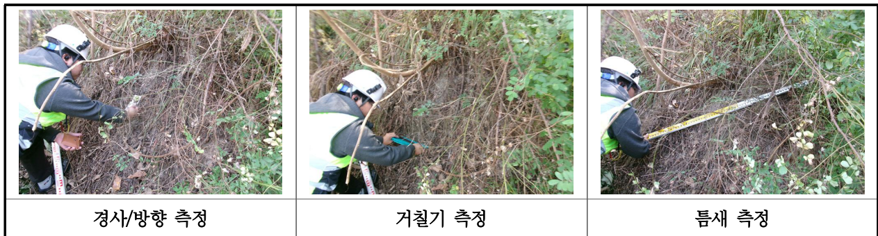
【사진 12.3.3】 불연속면 측정 현황
